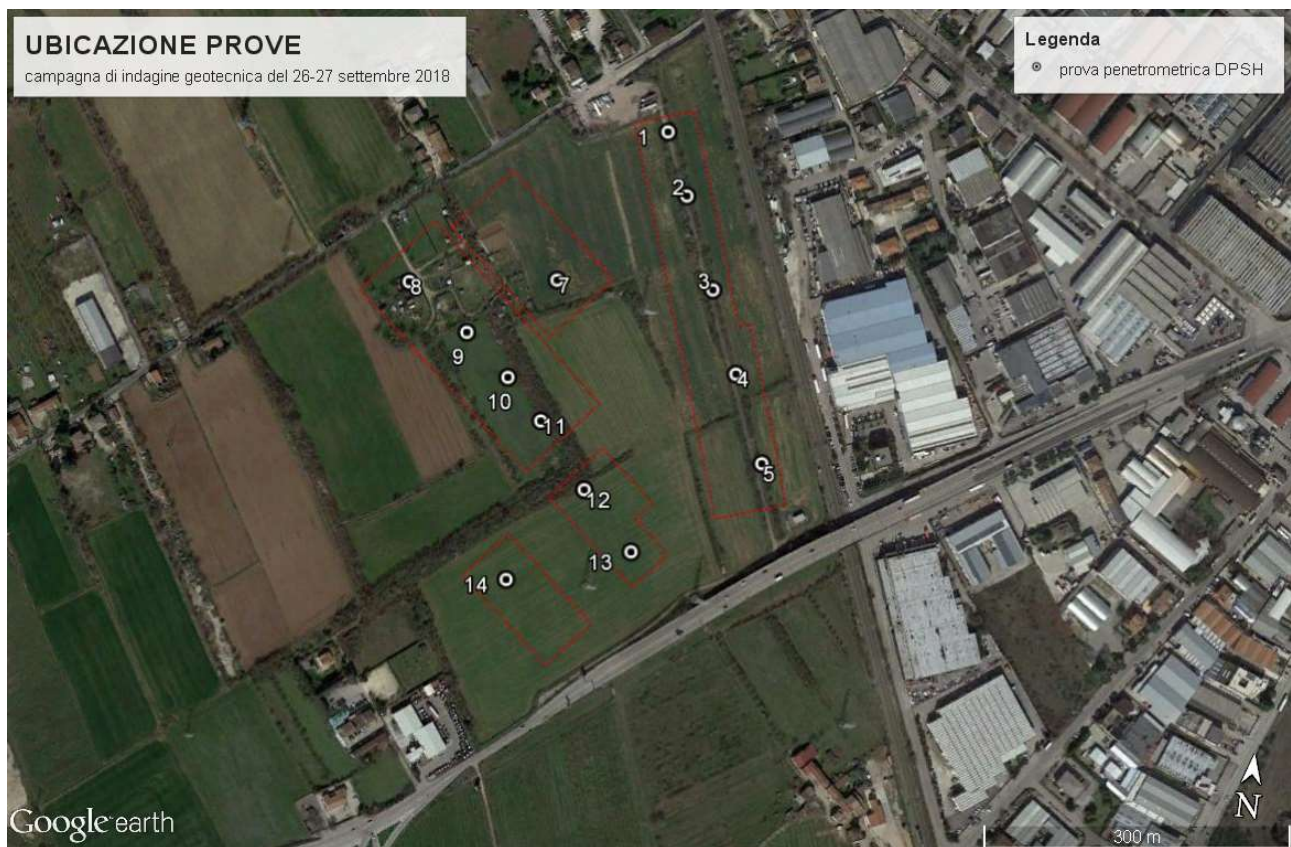
UBICAZIONE PROVE PENETROMETRICHE
